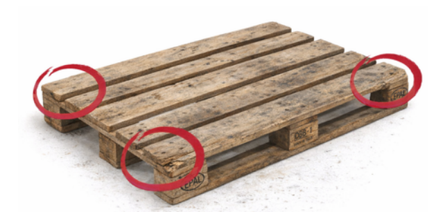
Mehr als zwei Boden- oder Deckrandbretter sind so abgesplittert, dass mehr als ein Nagel oder Schraubenschaft sichtbar ist.
