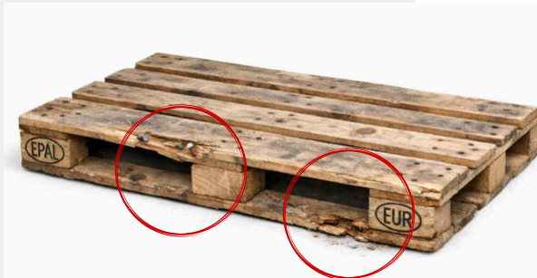
Ein Boden- oder Deckrandbrett ist so abgesplittert, dass mehr als ein Nagel oder Schraubenschaft sichtbar ist.
