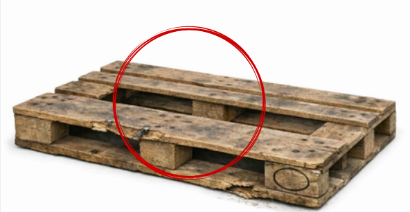
Ein Boden- oder Deckrandbrett ist so abgesplittert, dass mehr als ein Nagel oder Schraubenschaft sichtbar ist.
