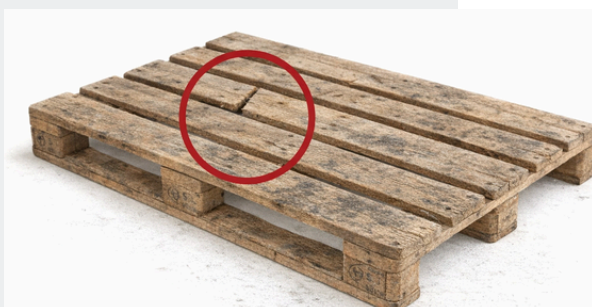
Ein Brett ist quer oder schräg gebrochen.
