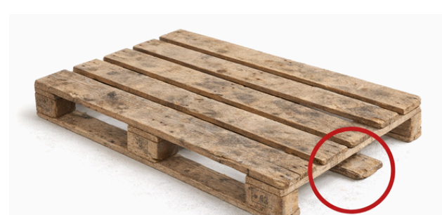
Ein Klotz fehlt oder ist so gespalten, dass mehr als ein Nagel sichtbar ist.
