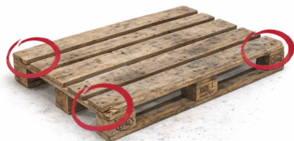
Mehr als zwei Boden- oder Deckrandbretter sind so abgesplittert, dass mehr als ein Nagel oder Schraubenschaft sichtbar ist.
