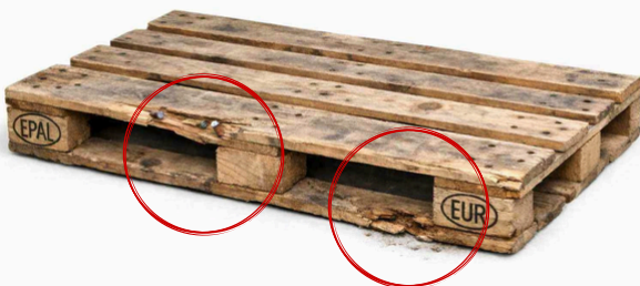
Ein Boden- oder Deckrandbrett ist so abgesplittert, dass mehr als ein Nagel oder Schraubenschaft sichtbar ist.
