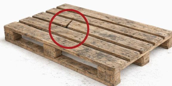
Ein Brett ist quer oder schräg gebrochen.
